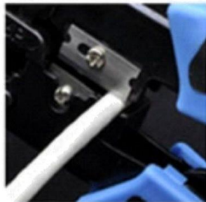
2.將網路線放入壓線鉗剝線口，輕按線鉗，讓網路線旋轉一圈，注意不要傷到芯線
