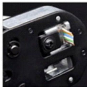
7.將水晶接頭放入壓線鉗壓接模口中進行壓接，切斷多餘的線芯
