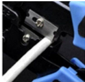
2. 將網路線放入壓線鉗剝線口，輕按線鉗，讓網路線旋轉一圈，注意不要傷到芯線
