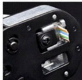
7. 將水晶接頭放入壓線鉗壓接模口中進行壓接，切斷多餘的線芯
