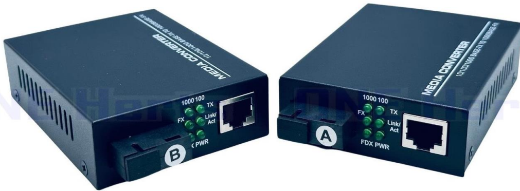
OHZ-SC1000 千兆單模單芯光電轉換器
